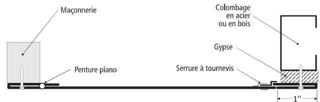
La porte **RPL** est **faite de plastique et son panneau est amovible**. Elle peut être utilisée pour faciliter l'accès aux réseaux mécanique, aux fils électriques, aux câbles informatiques et aux systèmes de gicleurs. Son cadre réversible en permet une installation de type encastré.
